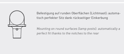
Befestigung auf runden Oberflächen (Lichtmast): automatisch perfekter Sitz dank rückseitiger Einkerbung
