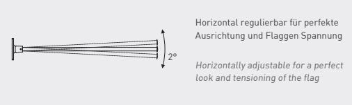
Horizontal regulierbar für perfekte Ausrichtung und Flaggen Spannung
